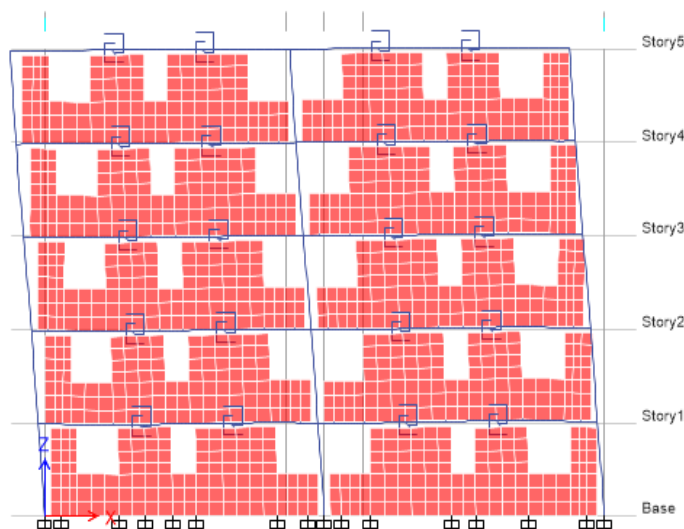
Figura 4. 4. Segundo modo de vibración (Estructura con SLB)
