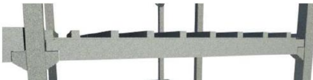
Figura 5. 12. Esquema prelosa apoyada por viga semiprefabricada. Fase 1
