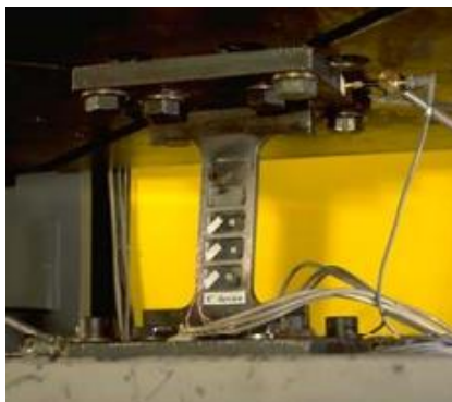
Figura 2. 15. Prototipo inicial de los disipadores SLB. (ISMES, Italia, 1997 )
