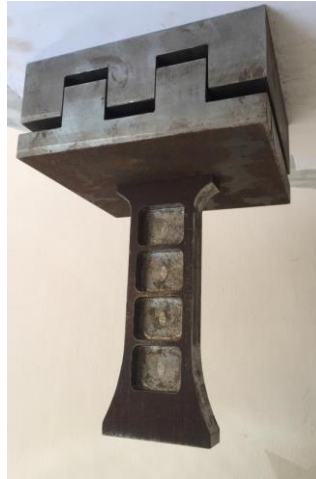
Figura 2. 17. Tercera generación del disipador sísmico SLB y conexión tipo peine.
