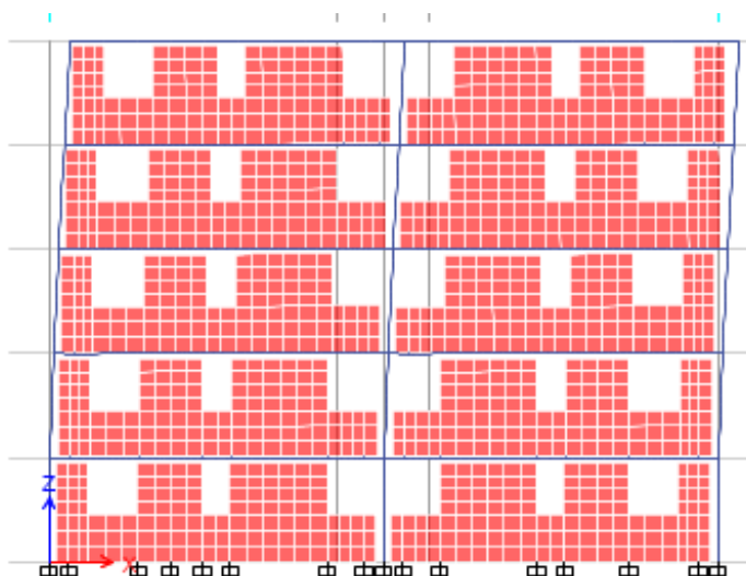
Figura 4. 6. Primer modo de vibración (Estructura sin SLB)
