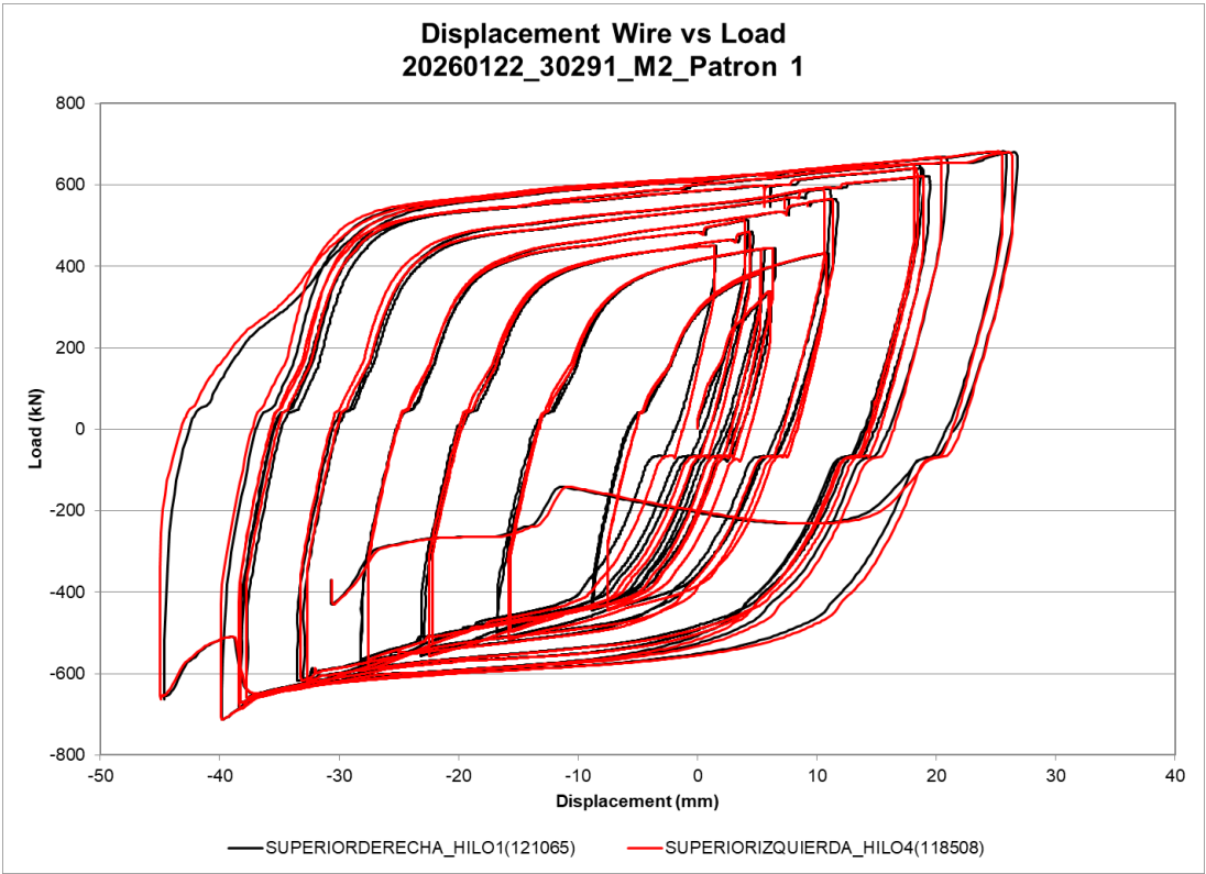
Figura 87: Desplazamiento del cable vs carga
