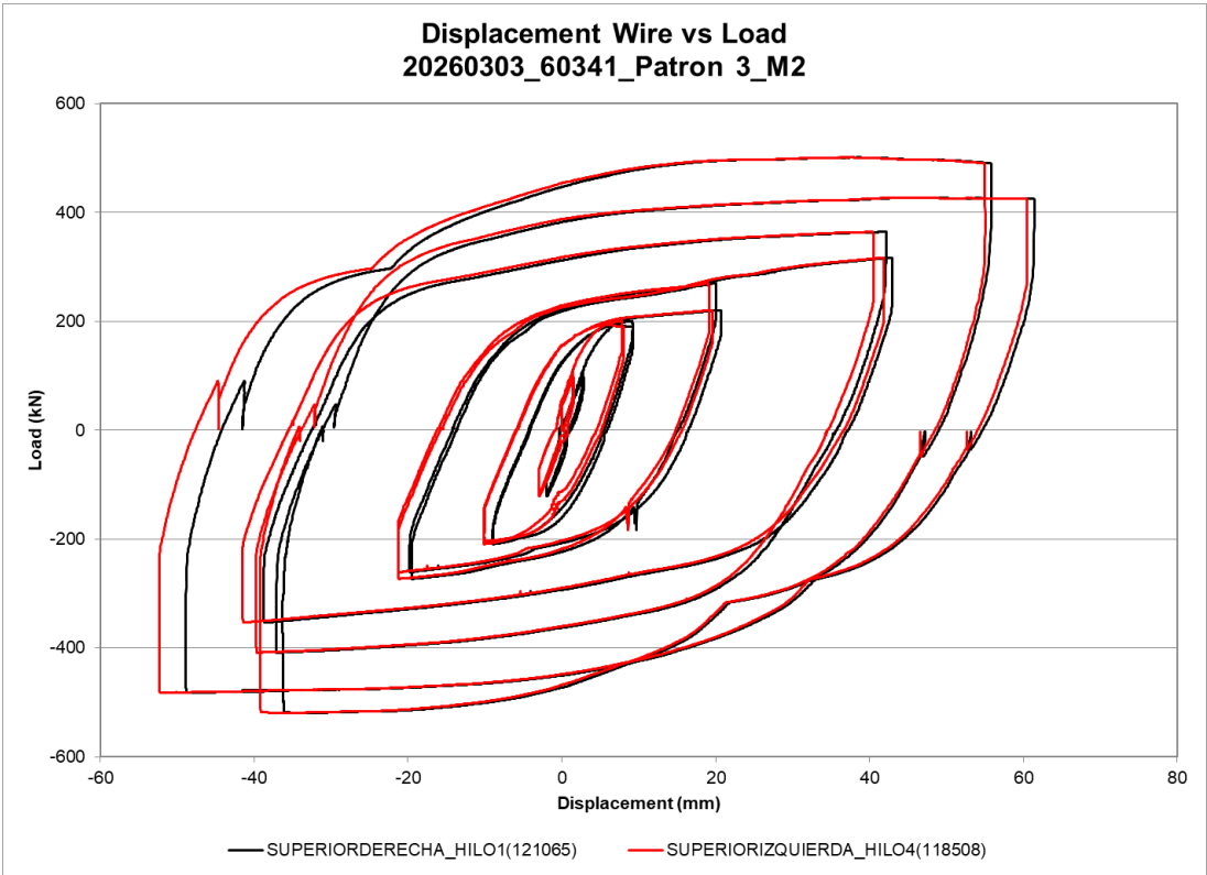
Figura 53: Desplazamiento del cable vs carga
