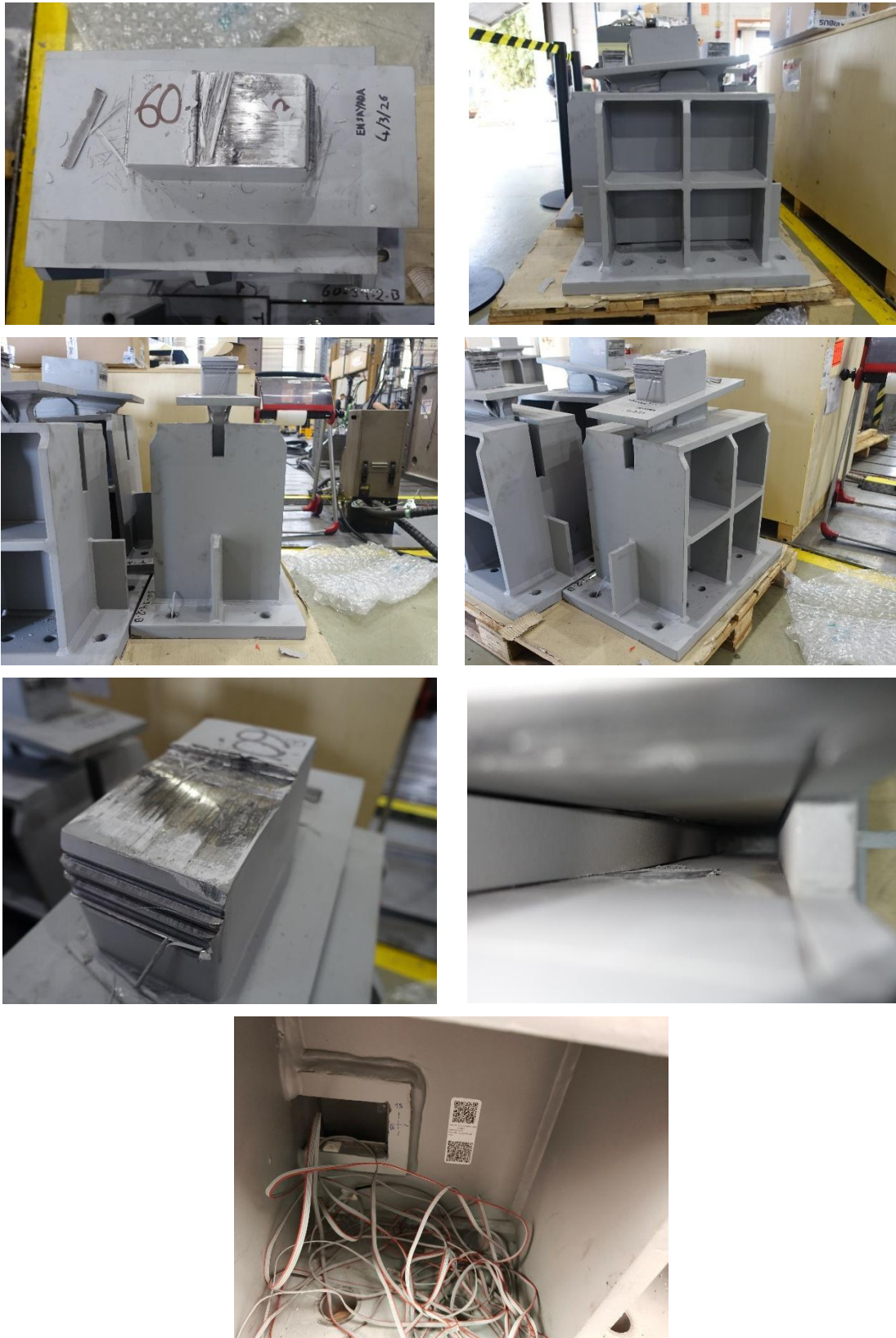
Figura 110: 15_BDSL60_34_3 después de ensayo. Galgas extensiométricas situadas a 40 cm de la base de la ventana inferior izquierda y a mitad del grosor.
