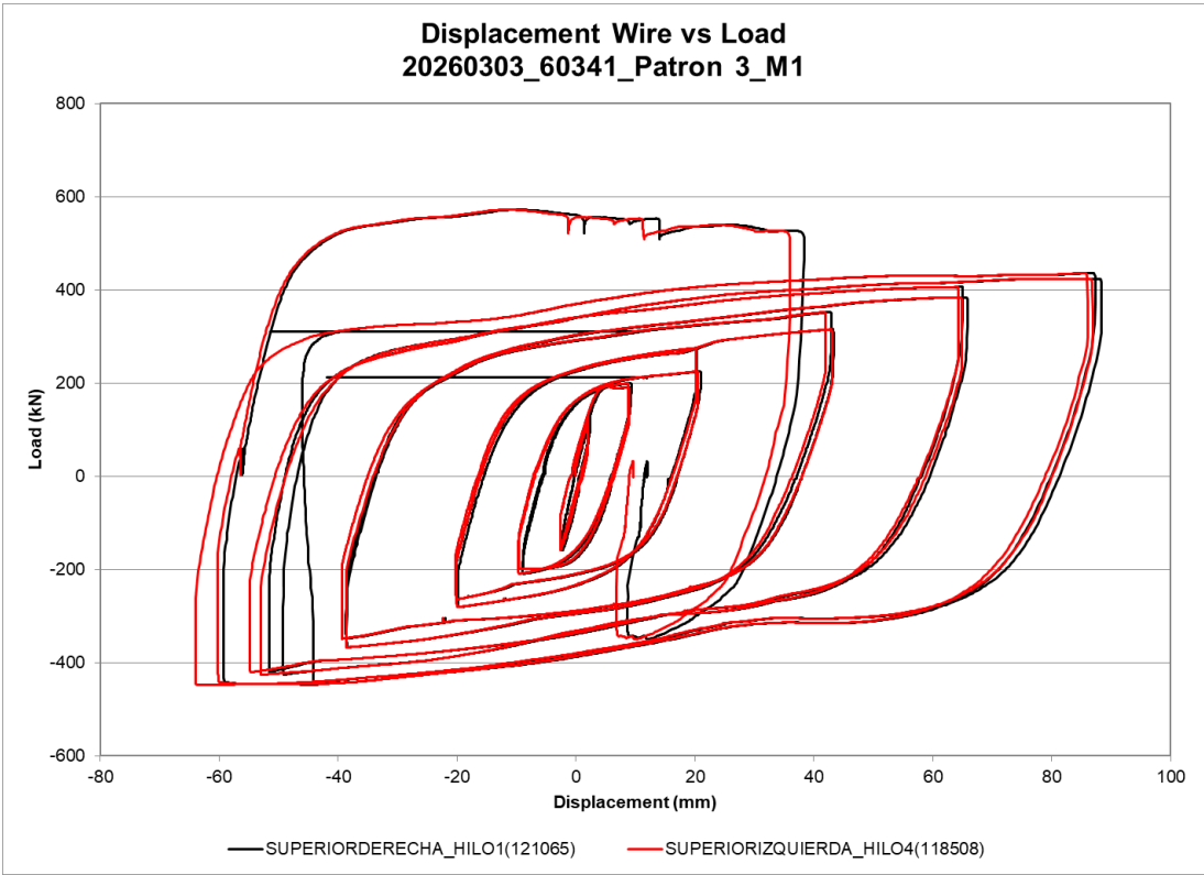
Figura 49: Desplazamiento del cable vs carga
