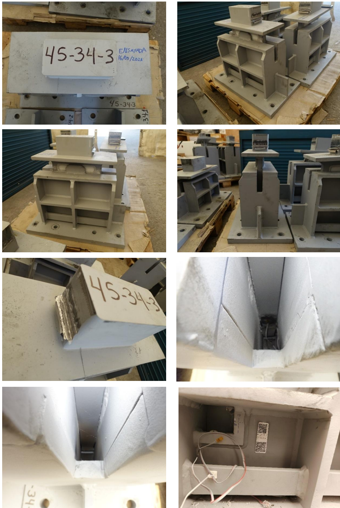
Figura 107: 12_BDSL45_34_3 después de ensayo. Bandas extensiométricas situadas a 40 cm de la base de la ventana inferior izquierda y a mitad del grosor.
