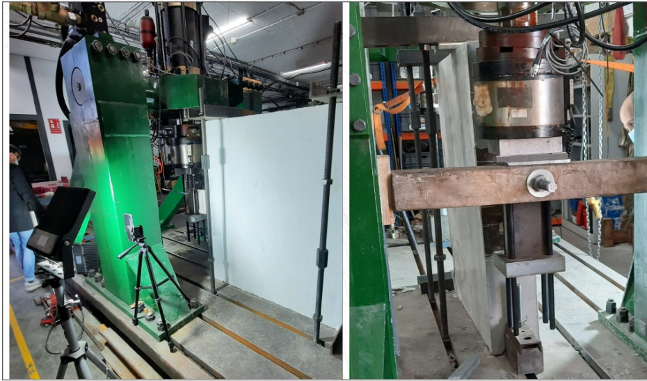
Figura 5. Detalle de la fijación de uno de los dissipadores en el banco de ensayos (izq.) y detalle del dissipador bajo el actuador (der.)
