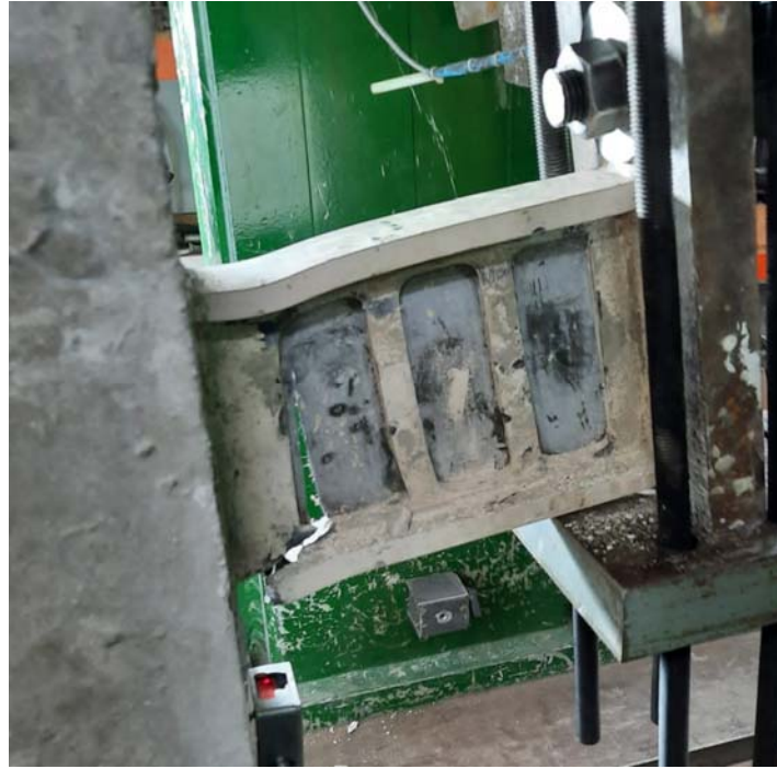
Figura 3.29. Estado del disipador al acabar el ensayo 3
