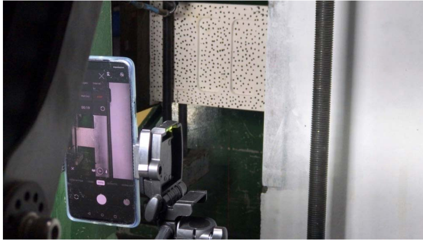
Figura 3.20. Disposición de la cámara para captar imágenes RAW durante el ensayo
