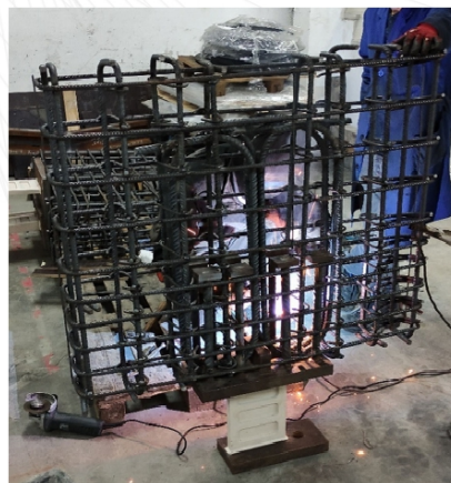
Figura 2. Aspecto de las barras corrugadas tras la preparación en la planta de prefabricados (izq.) y labores de soldadura realizadas en el laboratorio (der.).
