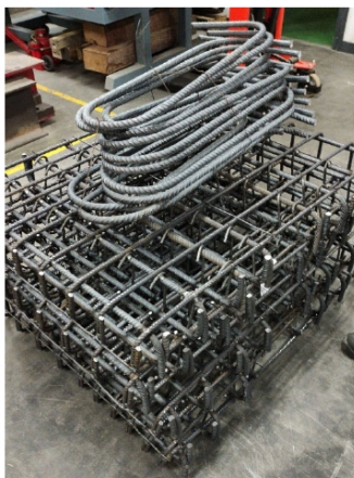
Figura 2. Aspecto de las barras corrugadas tras la preparación en la planta de prefabricados (izq.) y labores de soldadura realizadas en el laboratorio (der.).
