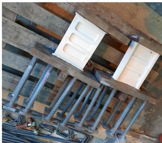
Figura 1. Aspecto de los dos tipos de disipadores ensayados en recepción, SLB4 20_5_Sin alas (izq.) y SLB4 20_5 (der.)
