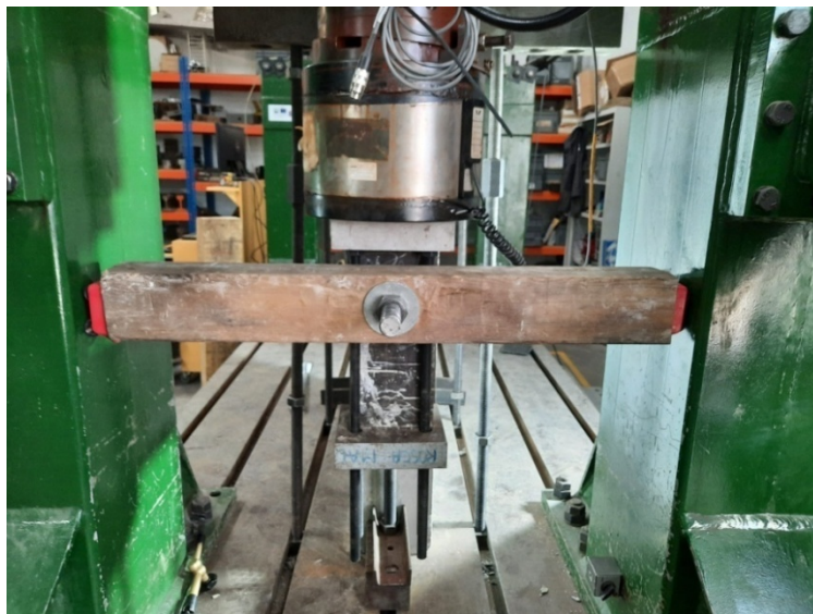
Figura 3.14. Viga de madera usada para restringir la rotación del dispositivo durante el ensayo
