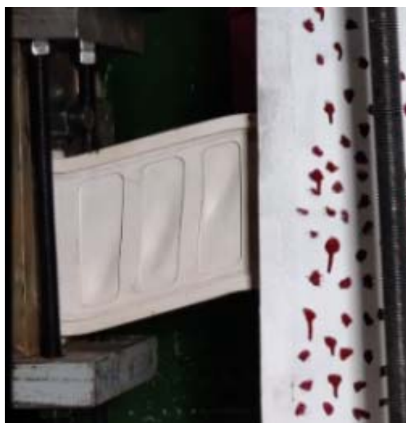
Figura 3.32. Inicio de abolladura en el dispositivo durante el ensayo 4
