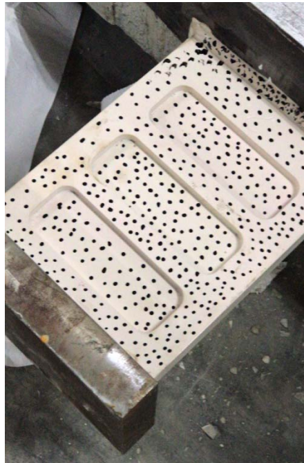
Figura 3.19. Dispositivo con mallado de puntos
