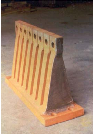
Figura 2.9. Disipadores TADAS y su comportamiento histerético
